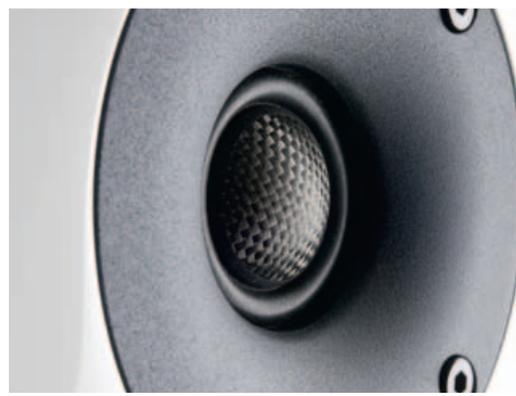
ten Biegeeigenschaften in den Mitteltönern optimal zur Geltung. Bei der Hochtonkalotte ist dagegen Härte gefragt. Deshalb besteht der 2,5 cm durchmessende Dome aus unzähligen parallelen Fasern, die wie in einem professionellen Rennradrahmen oder Formel-1-Monocoque mit einem Harz zu einer steifen, schallundurchlässigen Masse verbacken werden.
