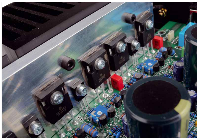
Hinter dem Kühlkörper auf einem Aluprofil montiert arbeiten die bipolaren Darlington-Transistoren
